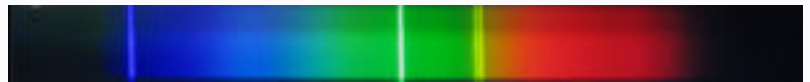
Täysspektrisen päivänvalolampun spektri. Väriämpötila 5500 K, värintoistoindeksi 96-97. Värit näkyvät erinomaisesti, lukeminen on helppoa.
