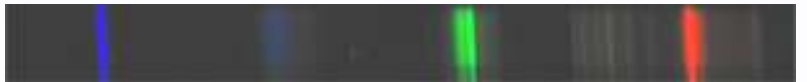
Tyypillisen 3-huippuisen loistelampun / täysvärilampun spektri. Värilämpötila 2700 - 8000 K, värintoistoindeksi 50-80. Värit vääristyvät täysin, lukeminen on sitä vaikeampaa ja hitaampaa, mitä vanhempi ihminen on. Nämä spektrit on nähtävänä AD-Luxin myymälässä olevalla spektrometrillä.
