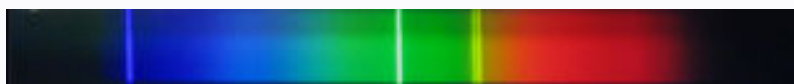
Täysspektrisen päivänvalolampun spektri. Väriämpötila 5500 K, värintoistoindeksi yli 96. Värit näkyvät erinomaisesti, lukeminen on helppoa.
