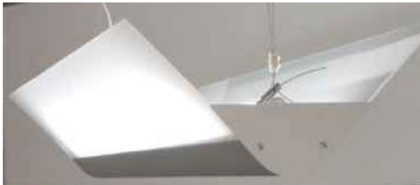
Kuvassa siivekkeet ovat satiinipintaista, 73 % valoa läpäisevää opaalimuovia, lev. 200 mm. Epäsuoraa valoa tulee runsaasti katon kautta sekä myös häikäisemätöntä valoa siivekkeiden kautta.
